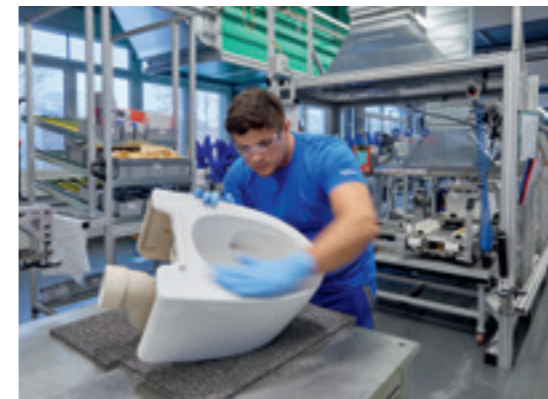
Montering av dusjtoaletter...
