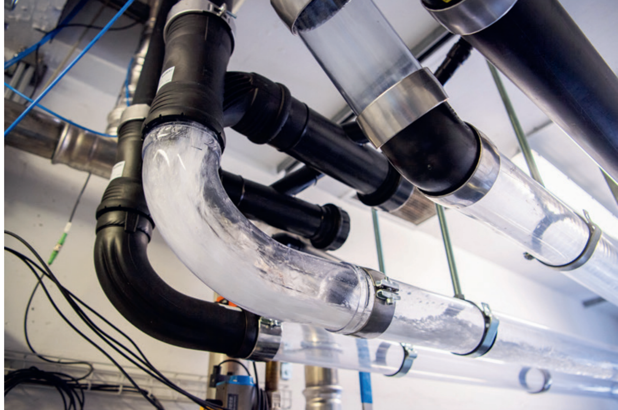
Testen med transparente deler gir innsikt i den faktiske flytoppførselen til de nye rørdelene
