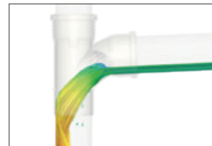
Med CFD (computational fluid dynamics) numerisk flytsimulering, kan versjoner testes virtuelt på forhånd...
